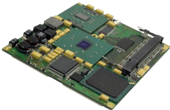
Bild 2: Das Computer-on-Module Kontron ETX-PM.
